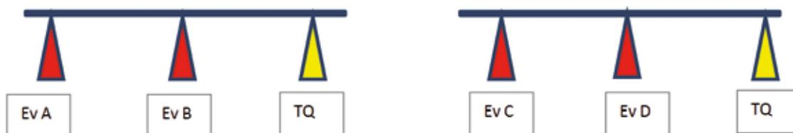
Fig. 1 – Schema della posizione delle elettrovalvole sulle barre
