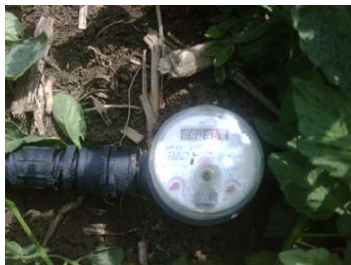
Foto 4 “Conta litri utilizzato su irrigazione a manichetta
